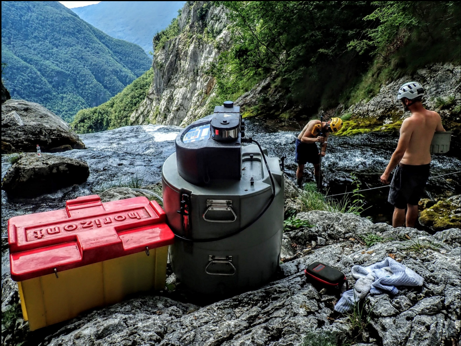
Installazione di campionatore automatico alla risorgiva di Boka, Slovenia. (foto KRI Postumia)
