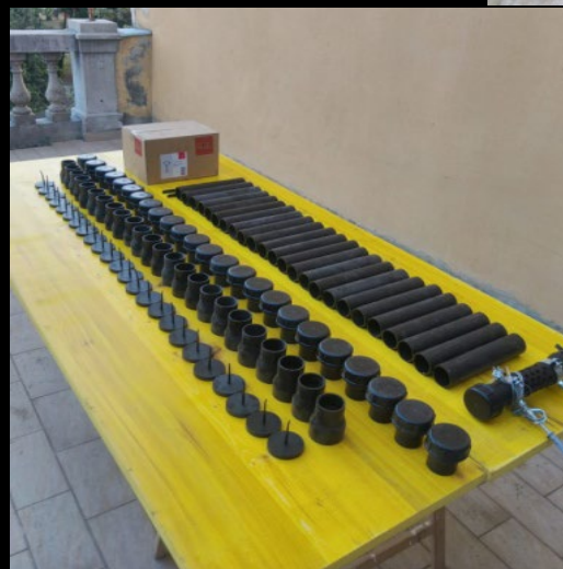
costruzione supporti protettivi per fluocaptori
