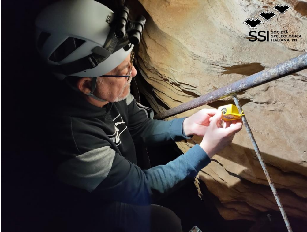
fig. 1 installazione termoisgrometro datalogger, foto Maria Grazia Fronteddu
