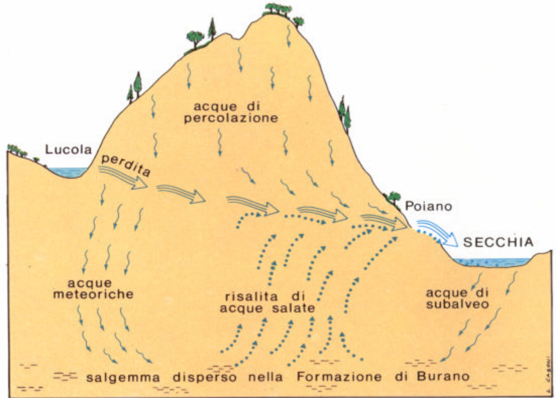
Schema della circolazione delle acque di alimentazione delle Fonti di Poiano.
