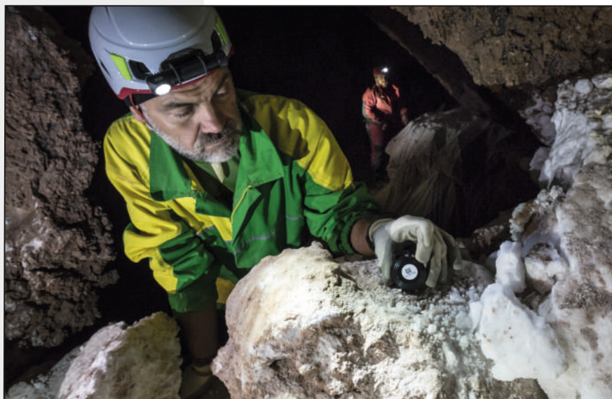
La messa in posto degli appositi rilevatori per lo studio del radon negli ambienti ipogei.
