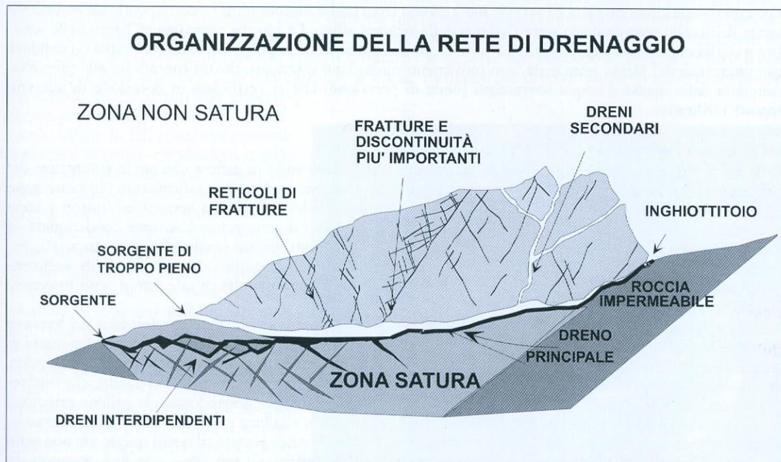
Fig. 3: Schematizzazione di un sistema carsico: le cavità di grosse dimensioni occupano un volume esiguo rispetto i settori dell'ammasso roccioso a permeabilità molto più ridotta
